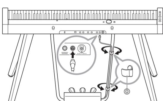
手順 8 でペダルコードを固定した ⑩ を背面側に回転させて、ペダルコードのプラグをピアノ本体背面のペダル端子に差し込みます。
