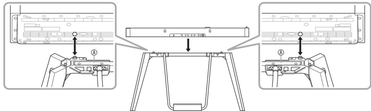
ピアノ本体底面と、④ 金属部品の位置を合わせて置きます。
