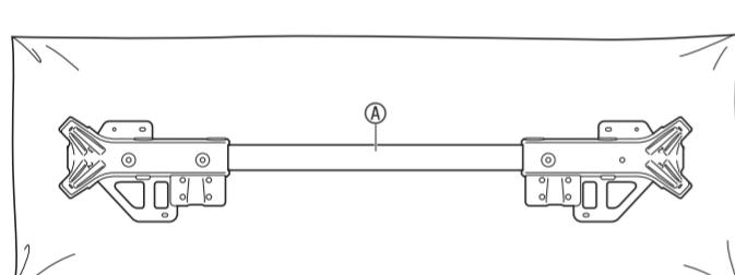
ピアノ本体の取付け側を下にして、④ を柔らかい布などの上に置きます。
